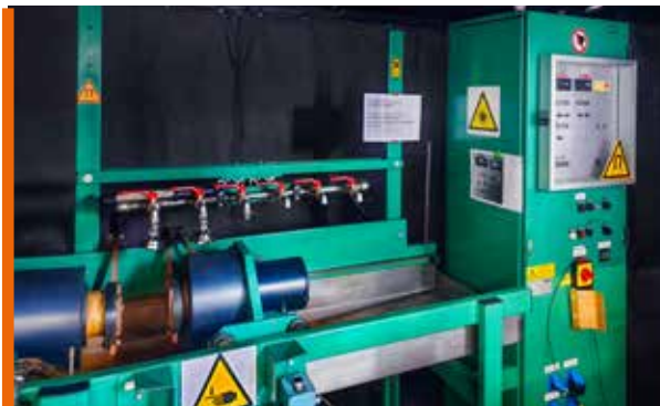
■ Magnetpulver-Rissprüfung
